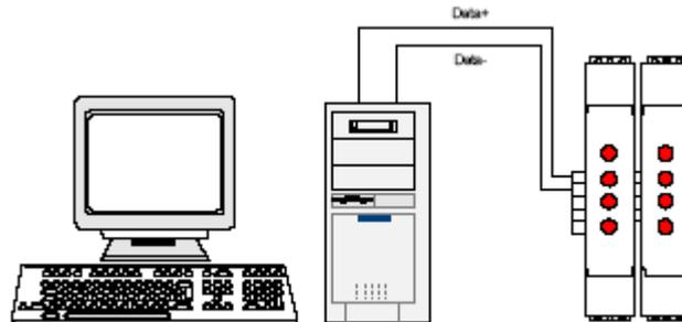
Если вычислитель не имеет встроенного интерфейса RS-485, то необходимо использовать преобразователь интерфейса RS-485/RS-232 типа WAD-RS232/485-BUS, или аналогичный.
