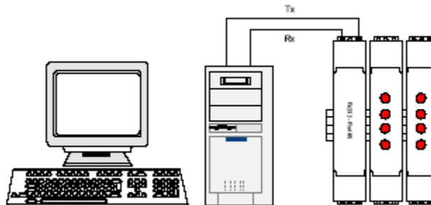
Каких-либо особенностей подключения интерфейса не имеет, нужно только учитывать, что допустимая протяжённость линии связи интерфейса RS-232 не превышает 10-20 метров, в то время как RS-485 позволяет проводить связь на расстоянии более километра. Чем длиннее линия связи, тем ниже будет максимально возможная скорость обмена. “Стандартной” является скорость 9600 бод, которая достаточна для решения подавляющего большинства задач.
