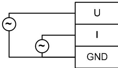
При этом вход тока может содержать внутри устройства токовый трансформатор. Конкретнее типы входов и диапазоны оговариваются при заказе. Назначение контактов разъема будет зависеть от выбранной конфигурации входов, а также от наличия дополнительных каналов, которые будут указаны в заказе на устройство.
