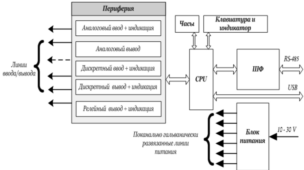
Рис 1. Обобщённая структурная схема модулей дискретного ввода-вывода WAD-P340-BUS.
