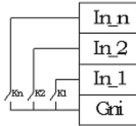
Типовая схема подключения входов дискретного ввода:
