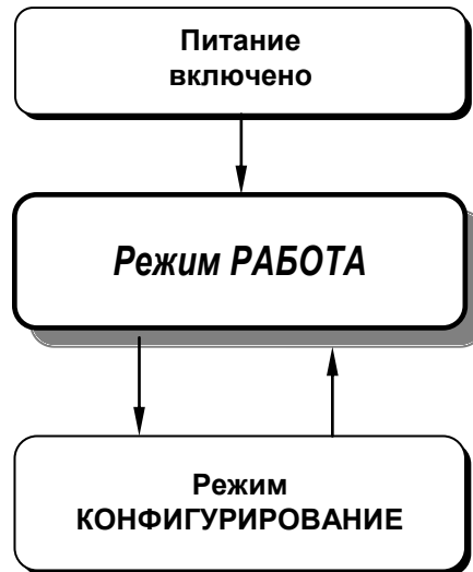
Рисунок 4.1 - Диаграмма режимов работы и настройки индикатора ИТМ-112
