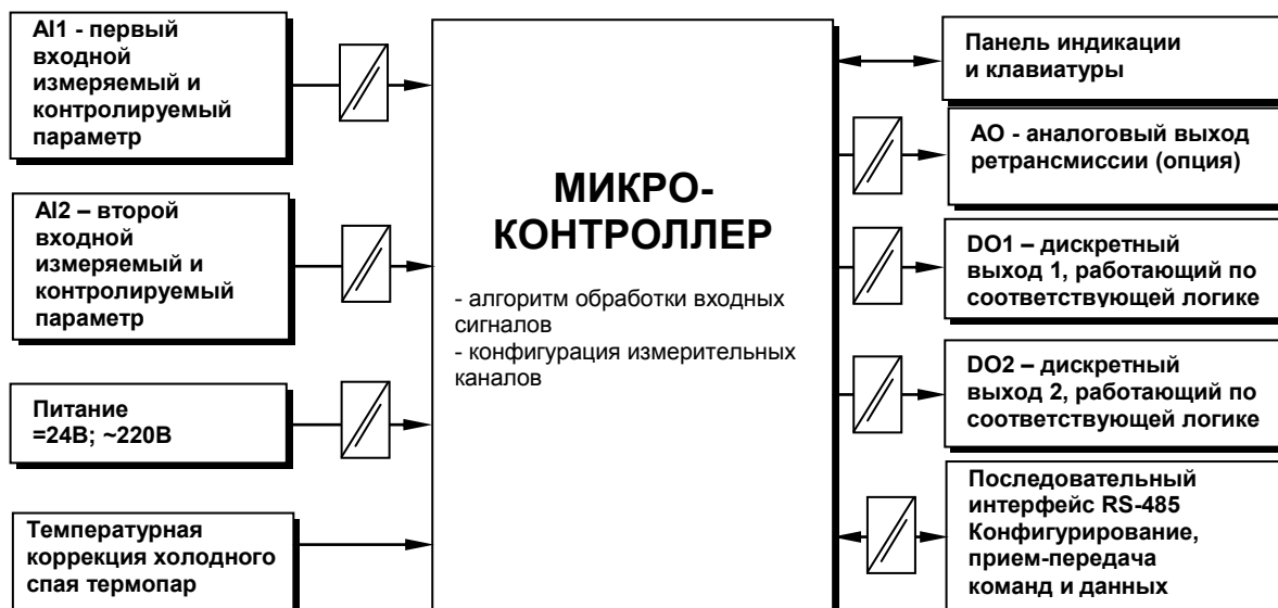
Рисунок 3.2 - Структурная схема индикатора ИТМ-112
