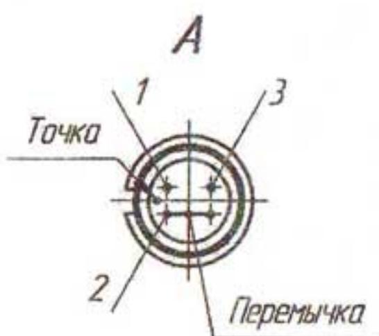
*Точка нанесена со стороны установки элемента измерительного*
